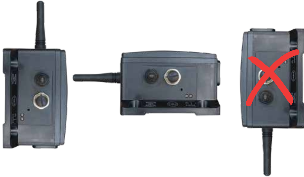
Figure 5.2 Comment positionner l'unité centrale.
