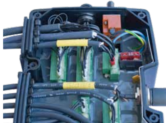
Figure 5.7 Orientation des câbles.
