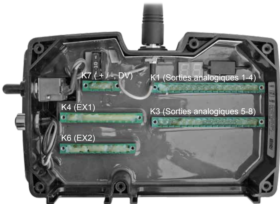
Figure 3.9 Terminaux de connexion interne des unités centrales standard type 2000 (Danfoss) et type 3000 (PWM).
