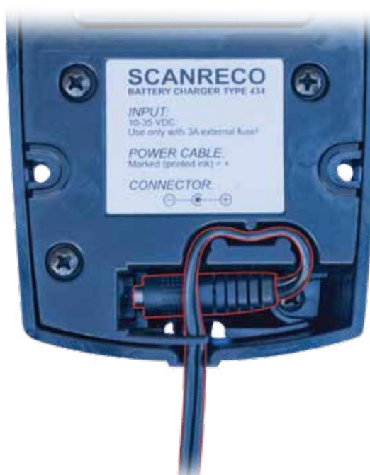
Figure 3.13 Positionnement du câble d'alimentation du chargeur de batterie.
