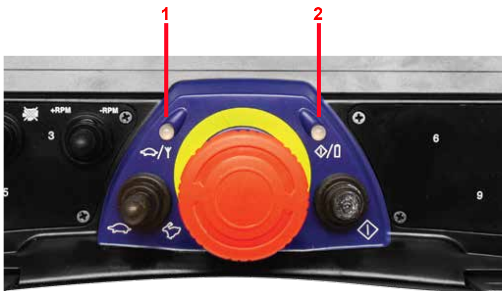
Figure 6.1 Indicateurs d'état et d'alarme sur le pupitre opérateur.
